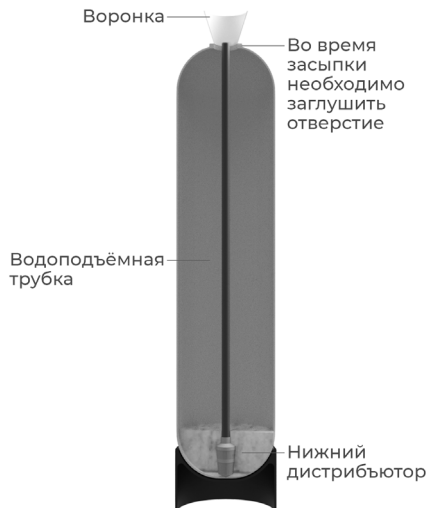
Заполнение фильтра материалом
